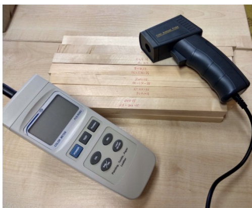
Рис. 3. Колориметр PCE-RGB 2 и образцы
