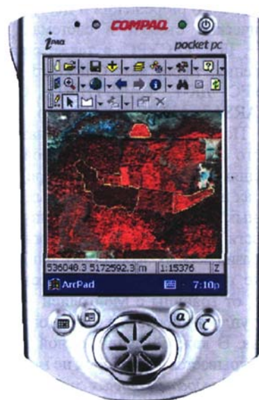
Рис. 2. Карманный компьютер Compaq iPAQ PocketPC для работы со спутниковыми изображениями IKONOS на координатных пробных площадях
